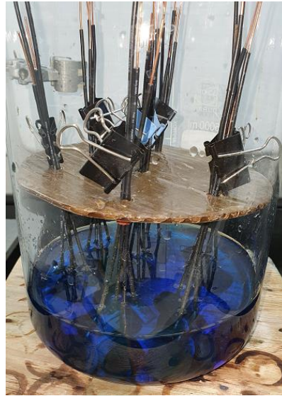
ภาพที่ 3.5 การเคลือบทองแดงด้วยวิธีไม่ใช้ไฟฟ้า ในสารละลายที่ผสมจาก \text{CuSO}_4 NaOH โปตัสเซียมไฮดรอกไซด์ และฟอมาลดีไฮด์
