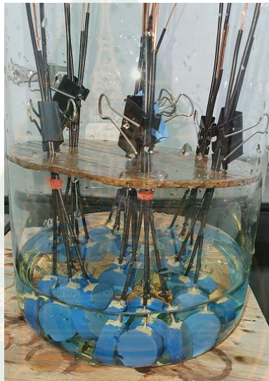
ภาพที่ 3.4 การกระตุ้นผิวครั้งที่ 2 ในสารละลายที่ผสมจาก \text{AgNO}_3 แอมโมเนีย และโปตัสเซียมโซเดียมตาเตรท
